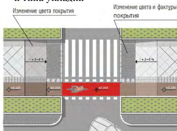
Схема 1-1. Пример организации предупреждающих покрытий при помощи изменения цвета, фактуры и типа укладки
