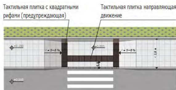
Схема 4. Наземный пешеходный переход, расположенный перпендикулярно движению пешехода на ограниченной территории. Ширина пешеходного тротуара — менее 3,0 м. Размещение тактильных указателей
