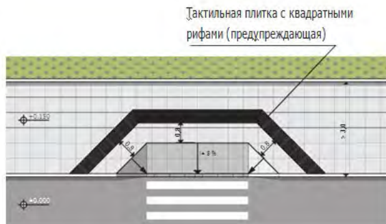
Схема 3. Наземный пешеходный переход. Ширина пешеходного тротуара — более 3,0 м. Размещение фактуры тактильных указателей
