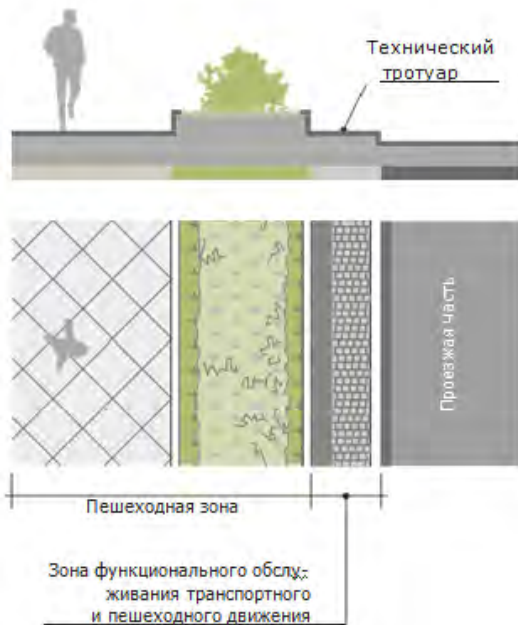
Технический тротуар, примыкающий к газону с высоким бортом
